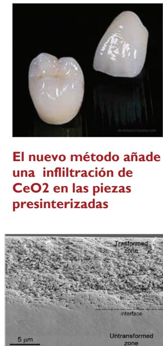
El nuevo método añade una infiltración de CeO<sub>2</sub> en las piezas presinterizadas
